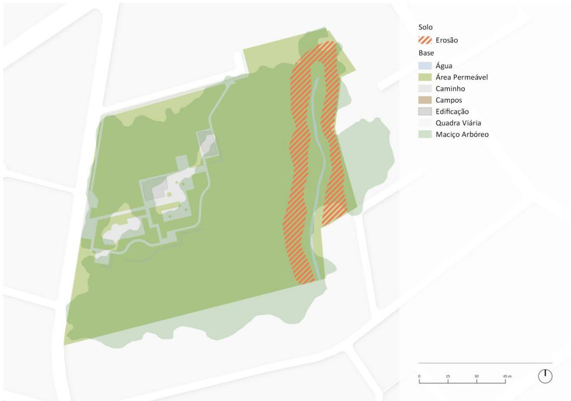
**Figura 6.** Áreas de erosão. Fonte: PMSP
